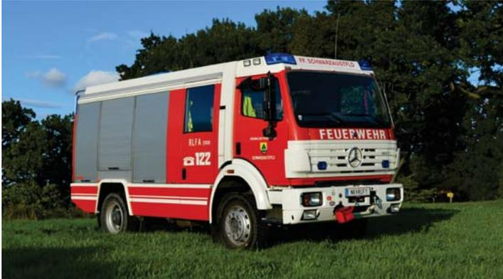
Marke Mercedes-Benz; Baujahr 2000; Aufbau Rosenbauer; Kennzeichen NK-RLF1; Besatzung 1:8; Ausrüstung Hydraulisches Rettungssset mit Schere, Spreitzer und Zylinder, Hebekissen, Seilwinde, 3 AT-Geräte, Generator, Notstromaggregat, Lichtmast, 2000l Wasser
