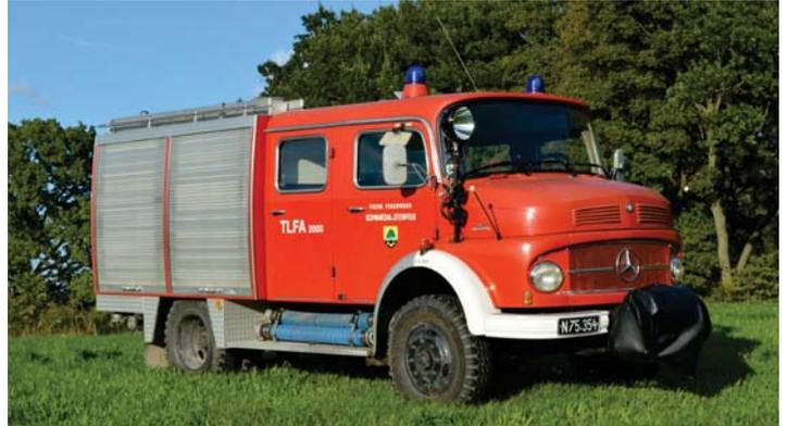
Marke Mercedes-Benz; Baujahr 1976; Aufbau Rosenbauer; Kennzeichen 75.354; Besatzung 1:6; Ausrüstung Seilwinde, 3 AT-Geräte, Diverse kleinere Geräte zur Brandbekämpfung, 2000l Wasser
