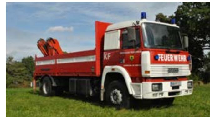
Marke Iveco; Baujahr 1991; Aufbau Eigenbau; Kennzeichen NK-FF122; Besatzung 1:2; Ausrüstung Ladefläche, Heckkran, Anschlagmittel, Hebekreuz und div. Geräte für Kranarbeiten
