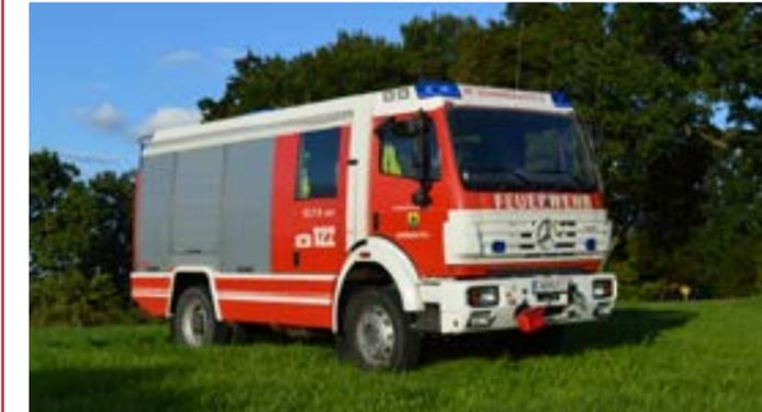
Marke Mercedes-Benz; Baujahr 2000; Aufbau Rosenbauer; Kennzeichen NK-RLF1; Besatzung 1:8; Ausrüstung Hydraulisches Rettungssset mit Schere, Spreizer und Zylinder, Hebekissen, Seilwinde, Gaswarngerät, Ölgrundweherset, 3 AT-Geräte, Notstromaggregat, Lichtmast, 2000l Wasser
