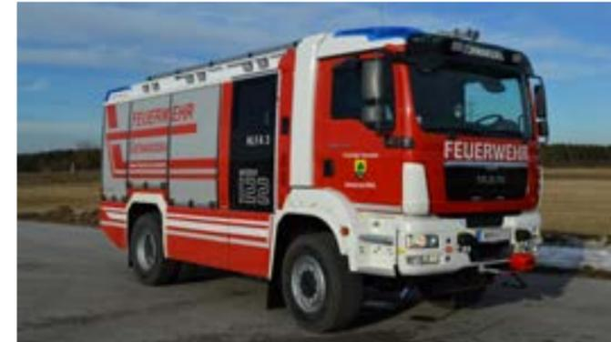
Marke MAN; Baujahr 2017; Aufbau Rosenbauer; Kennzeichen NK-HLF3; Besatzung 1:7; Ausrüstung Wasserwerfer, Mobiler Wasserwerfer, Seilwinde, Be- und Entlüftungsgerät, Druckbelüfter, Leichtschäumgenerator, Rauchvorhang, Wärmebildkamera, Gaswarngerät, 3 AT-Geräte, Notstromaggregat, Lichtmast, 4000l Wasser
