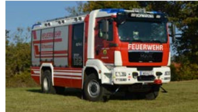
Marke MAN; Baujahr 2017; Aufbau Rosenbauer; Kennzeichen NK-HLF3; Besatzung 1:7; Ausrüstung Wasserwerfer, Mobiler Wasserwerfer, Seilwinde, Be- und Entlüftungsgerät, Druckbelüfter, Leichtschamgenerators, Rauchvorhang, Wärmebildkamera, Gaswarngerät, 3 AT-Geräte, Notstromaggregat, Lichtmast, 4.000l Wasser
