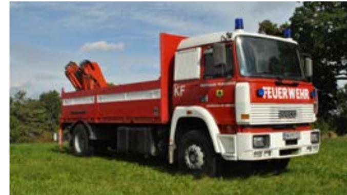
Marke Iveco; Baujahr 1991; Aufbau Eigenbau; Kennzeichen NK-FF122; Besatzung 1:1; Ausrüstung Ladefläche, Heckkran, Anschlagmittel, Hebekreuz und Geräte für Kranarbeiten
