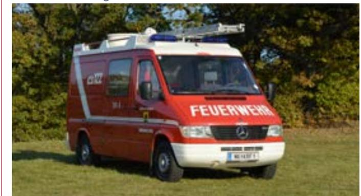
Marke Mercedes-Benz; Baujahr 1996; Aufbau Rosenbauer; Kennzeichen NK-KRF1; Besatzung 1:4; Ausrüstung Hydraulisches Rettungsset mit Schere, Spreizer und Zylinder, Notstromaggregat, Lichtmast, Greifzug
