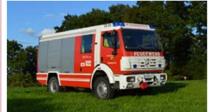
Marke Mercedes-Benz; Baujahr 2000; Aufbau Rosenbauer; Kennzeichen NK-RLF1; Besatzung 1:8; Ausrüstung Hydraulisches Rettungsset mit Schere, Spreizer und Zylinder, Hebekissen, Seilwinde, Gaswarngerät, Ölgrundwehrset, 3 AT-Geräte, Notstromaggregat, Lichtmast, 2.000l Wasser
