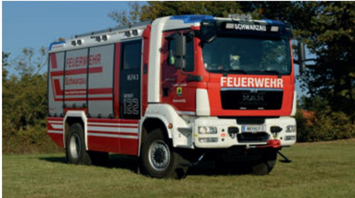
Marke MAN; Baujahr 2017; Aufbau Rosenbauer; Besatzung 1:7; Ausrüstung Wasserwerfer, Mobiler Wasserwerfer, Seilwinde, Be- und Entlüftungsgerät, Druckbelüfter, Leichtschäumgenerator, Rauchvorhang, Wärmebildkamera, Gaswarngerät, 3 AT-Geräte, Notstromaggregat, Lichtmast, 4.000l Wasser
