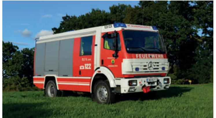
Marke Mercedes-Benz; Baujahr 2000; Aufbau Rosenbauer; Besatzung 1:8; Ausrüstung Hydraulisches Rettungssset mit Schere, Spreizer und Zylinder, Hebekissen, Seilwinde, Gaswarngerät, Ölgrundwehrset, 3 AT-Geräte, Notstromaggregat, Lichtmast, 2.000l Wasser
