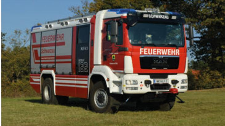
Marke MAN; Baujahr 2017; Aufbau Rosenbauer; Besatzung 1:7; Ausrüstung Wasserwerfer, Mobiler Wasserwerfer, Seilwinde, Be- und Entlüftungsgerät, Druckbelüfter, Leichtschaumgenerator, Rauchvorhang, Wärmebildkamera, Gaswarngerät, 3 AT-Geräte, Notstromaggregat, Lichtmast, 4.000l Wasser
