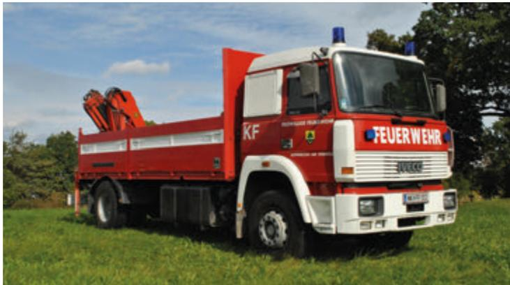
Marke Iveco; Baujahr 1991; Aufbau Eigenbau; Besatzung 1:1; Ausrüstung Ladefläche, Heckkran, Anschlagmittel, Hebekreuz und Geräte für Kranarbeiten
