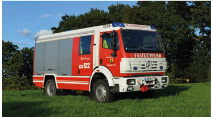
Marke Mercedes-Benz; Baujahr 2000; Aufbau Rosenbauer; Besatzung 1:8; Ausrüstung Hydraulisches Rettungsset mit Schere, Spreizer und Zylinder, Hebekissen, Seilwinde, Gaswarngerät, Ölgrundwehrset, 3 AT-Geräte, Notstromaggregat, Lichtmast, 2.000l Wasser
